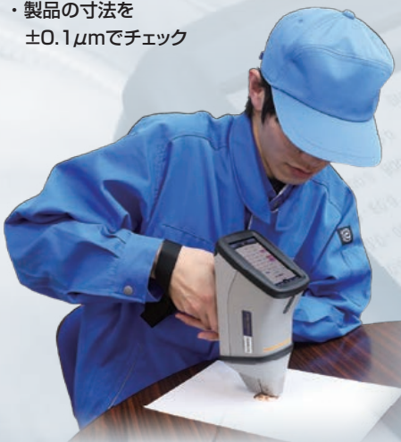
HITACHI X-MET8000 〈蛍光X線分析装置〉 ・金属成分分析 ・有害物検査
